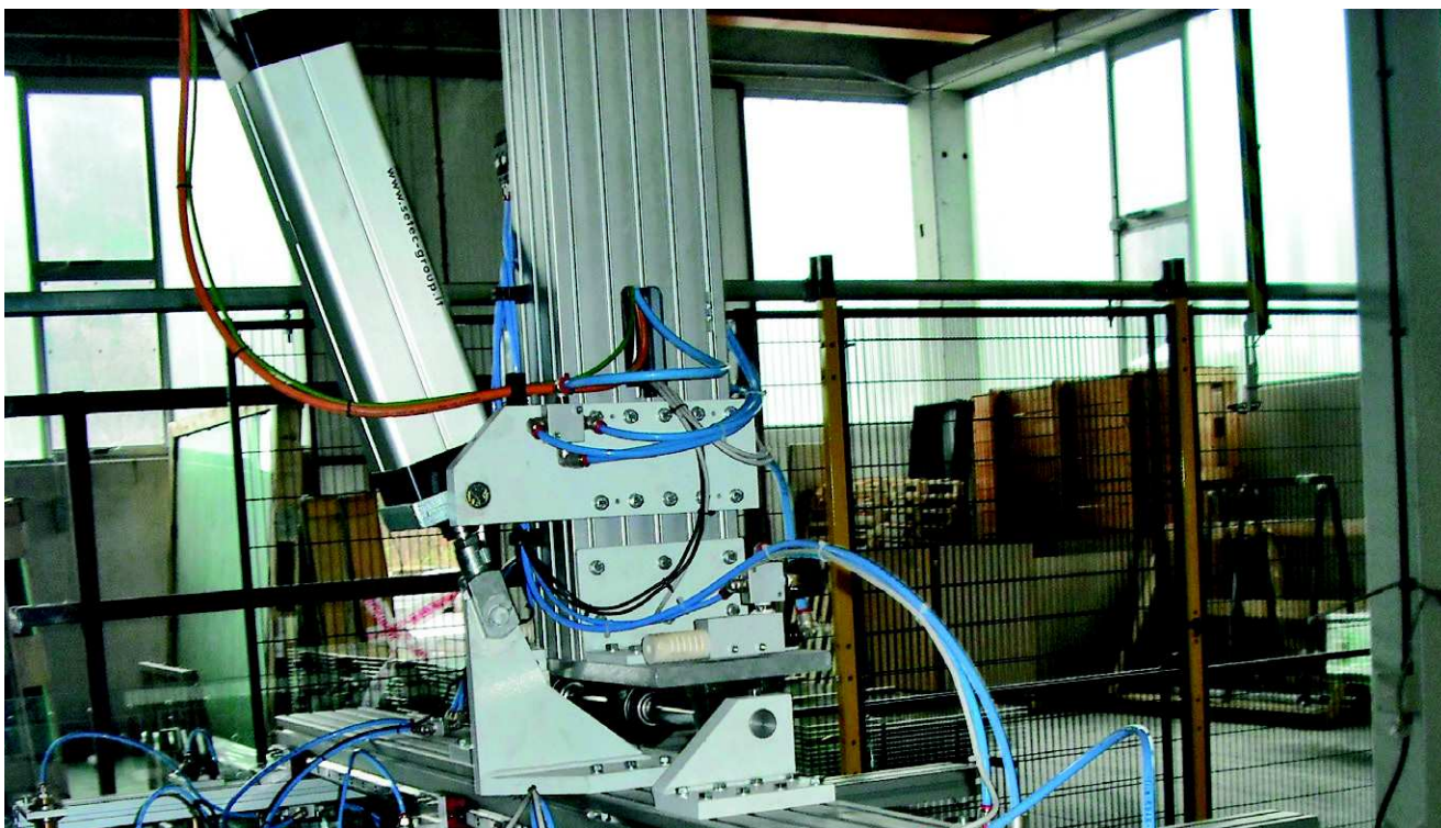
Ribaltatore lastre in vetro / Glass panel tilter
