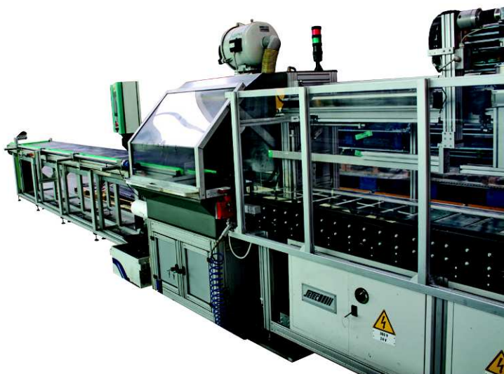
Linea automatica taglio di precisione viti/cromati / Chrome tubes/screws precision cutting automated machine
